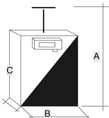
Distance axe tuyau / mur = min 15 cm
